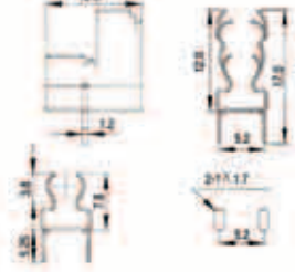
CQ-216, для предохранителей Ø10,3 мм
