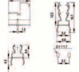
CQ-216E, для предохранителей Ø10,3 мм с крепежом под винт
